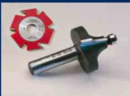
5. Fräswerkzeuge müssen für Handvorschub zugelassen sein (z. B. BG-TEST-Prüfzeichen)
