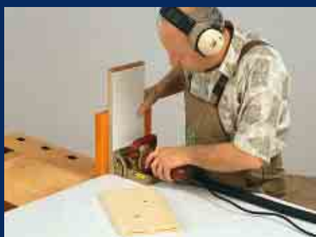
8. Einfräsen von Nuten mit Stützwinkel
