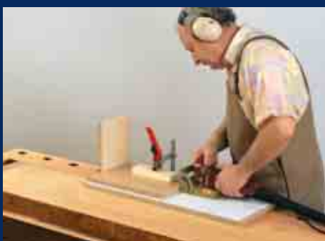
7. Einfräsen von Nuten; kleine Werkstücke festspannen
