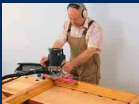
6. Einfräsungen für Beschläge, Beschlagteile mit geeigneten Schablonen
