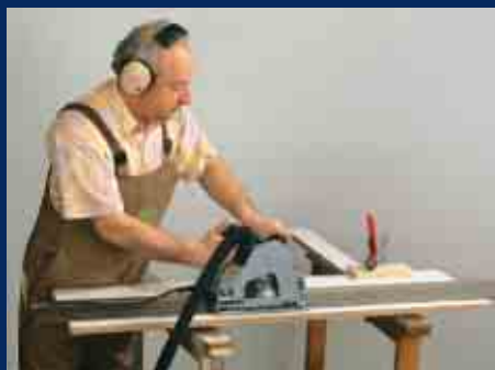
2. Zuschneiden von Massivholz mit Führungsschiene
