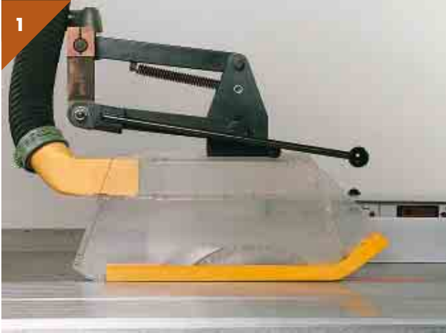
1 Spaltkeil und Schutzhaube mit Absauganschluss bei den Arbeitsgängen verwenden.
